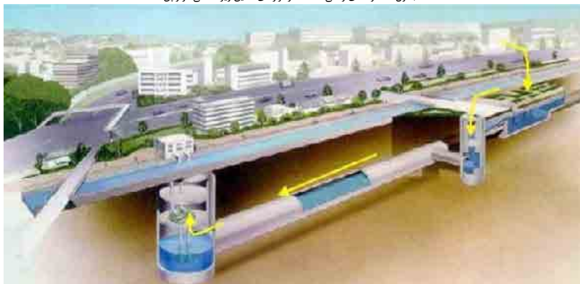
● شکل ۶: تونل اطمینان و راه آب رود Imai با حداکثر عمق ۸۵ متر
